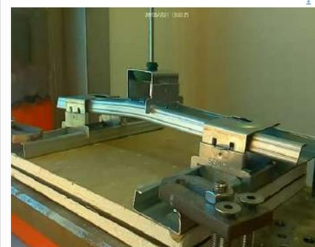
Disposición de ensayo: 21,4 Kg
