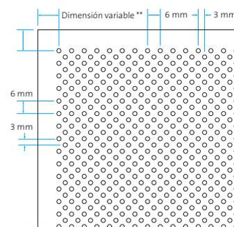
Perforación  $\text{Ø}$  2 mm
