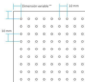
Perforación  $\text{Ø}$  2,5 mm
