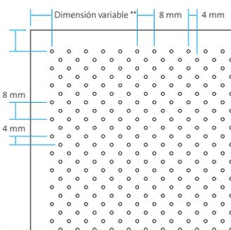
Perforación  $\text{Ø}$  1,5 mm
