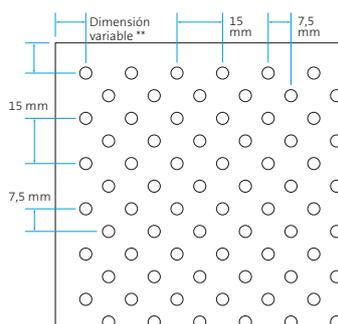
Perforación  $\text{Ø}$  4 mm
