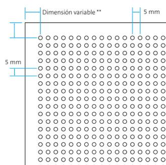
Perforación  $\text{Ø}$  2,5 mm
