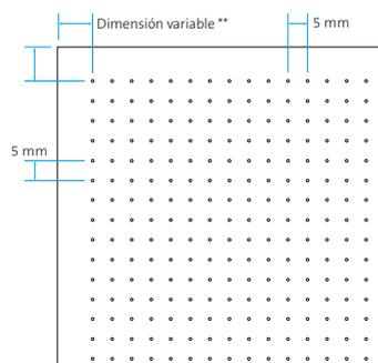
Perforación ultra-micro  $\text{Ø}$  0,7 mm
