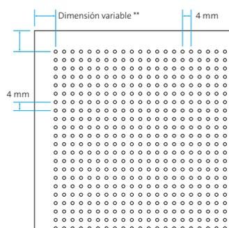
Perforación  $\text{Ø}$  1,5 mm
