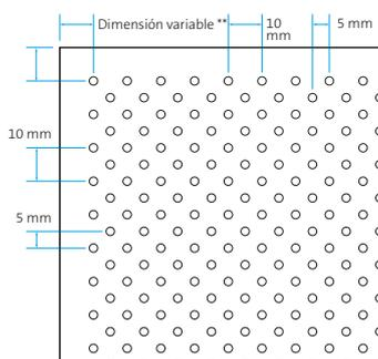
Perforación  $\text{Ø}$  2,5 mm
