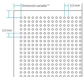
Perforación  $\text{Ø}$  2,5 mm
