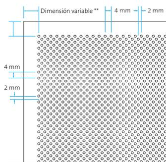
Perforación  $\text{Ø}$  1,5 mm
