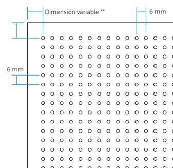
Perforación  $\text{Ø}$  2 mm
